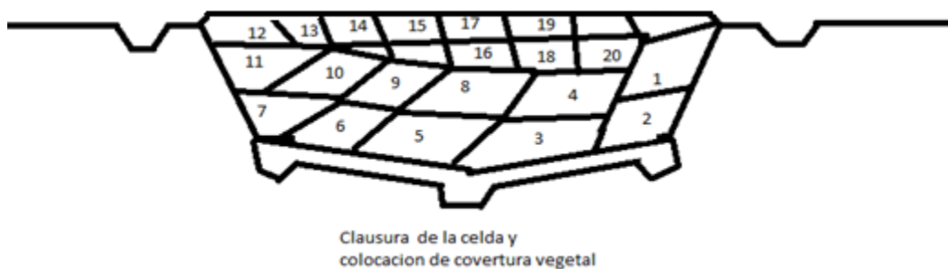
Figura 4. Forma final de la Trinchera al momento de su clausura.
